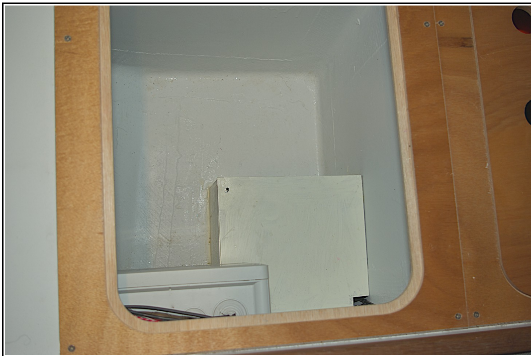
Boîte loch fermée. Etanchéité et fixation au sika.
