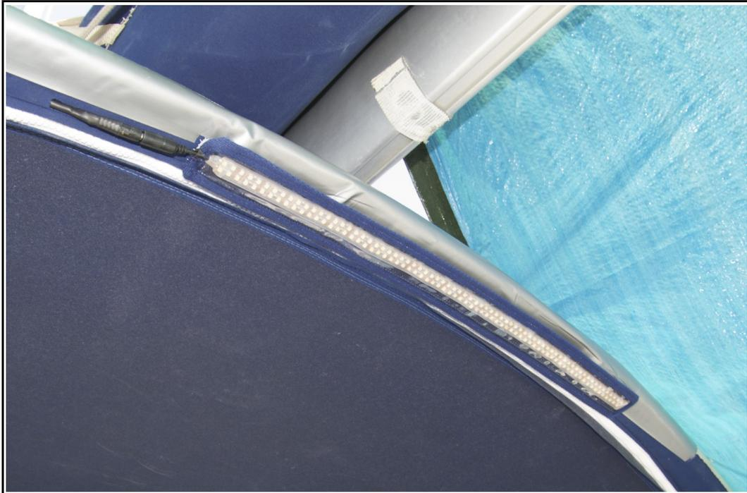
le bandeau de leds est sous protection le tout fixer par du velcro à la capote (qui est en mauvaise état...)
