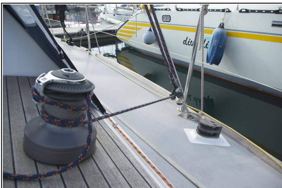
Maintenant le «clamcleat» est dans l'axe du winch et une pression du pied sur le bout permet de le libérer.
