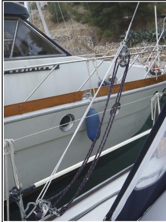
Elles restent à poste retenues par un sandow. C'est pas la peine d'avoir un enrouleur de trinquette et se balader à l'avant pour récupérer la bastaque (version 2010).
